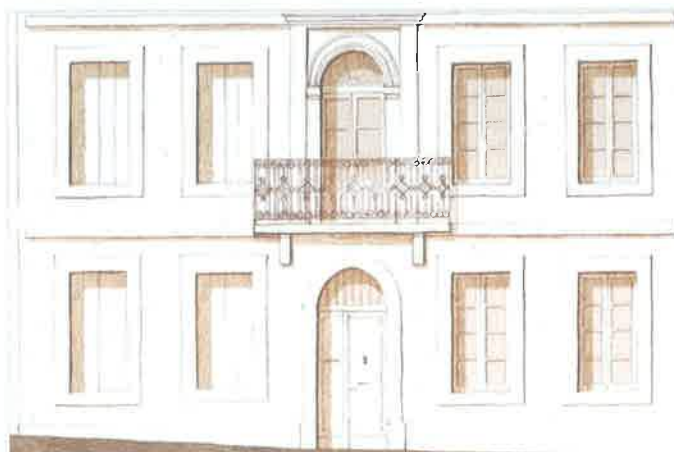
Balcon en encorbellement soulignant la travée centrale au 1 er étage.
